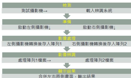
圖 6 採 3 個執行緒處理流程
