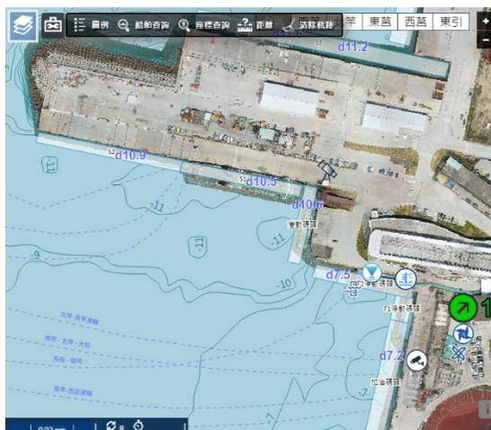
圖 5 正射影像與水深地形測量成果
