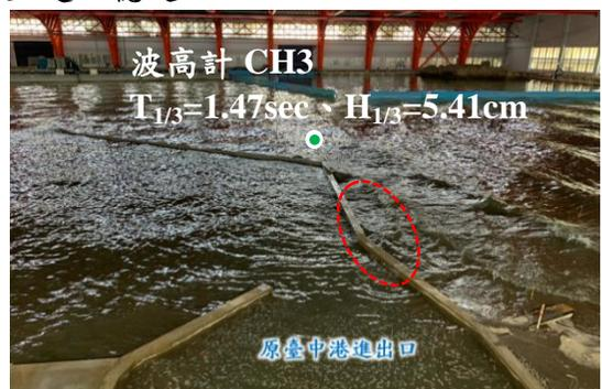
圖 4 冬季季風北防波堤試驗情形
