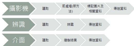
圖 5 即時辨識程式流程
