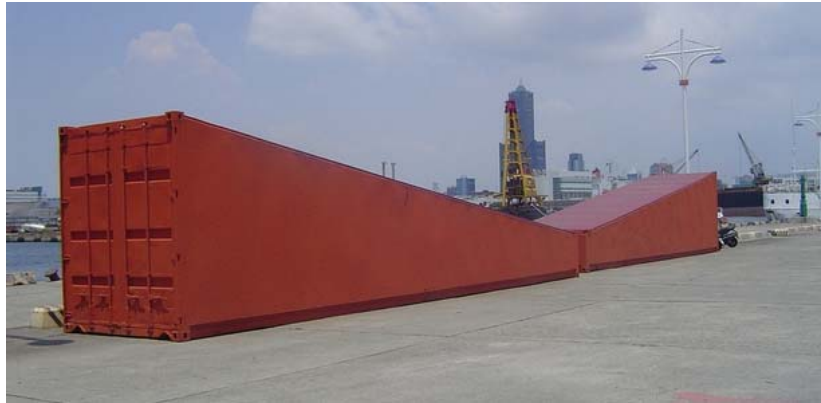
圖 2.17 疊合測量(Patch Test)目標物-傾斜貨櫃
